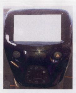
INSTALL THE AFTERMARKET RADIO AND REASSEMBLE THE DASHBOARD ON THE CAR IN REVERSE ORDER TO FINISH INSTALLATION
